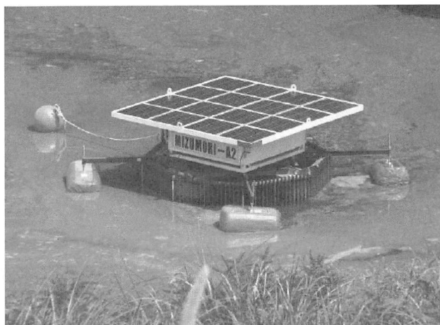
図-18 ダムに発生したアオコの自立自走型液中プラズマ装置による処理 50)
