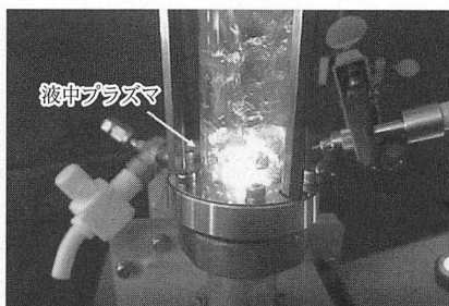
写真4 マイクロ波電源を用いた液中プラズマ発生の様子 (12)
