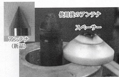
写真2 旧式液中プラズマ連続点灯によるタングステンアンテナ先端の劣化の様子 (12)
