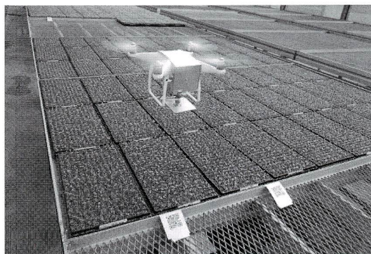
GaN半導体発振器を接続したドローンで植物にマイクロ波を照射し育成に有効な刺激を与える実験
