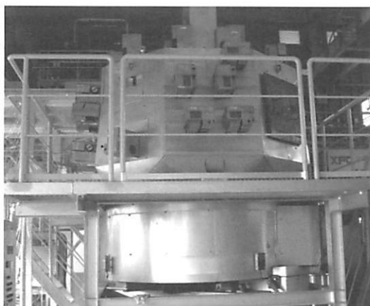
写真-4 土壌、飛灰、都市ゴミ中のダイオキシンを分解するためのマイクロ波焼却炉
