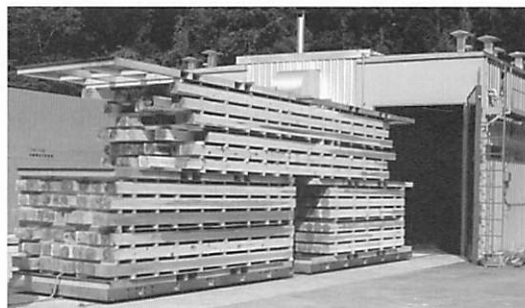
写真-3 蒸気式熱気乾燥および高周波乾燥を併用した複合化木材乾燥装置
